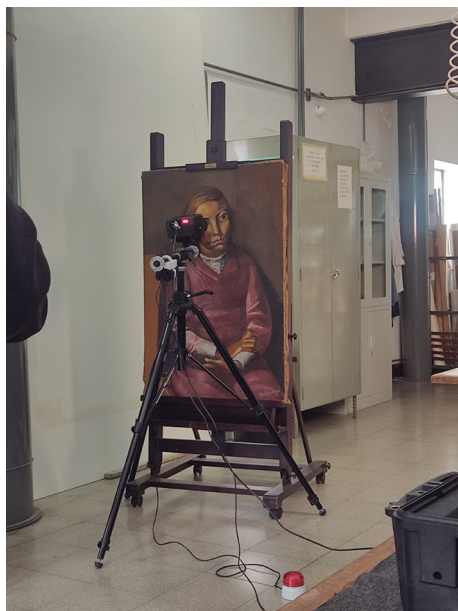
IMAGEN IZQUIERDA Medición de la Fluorescencia de Rayos X.
