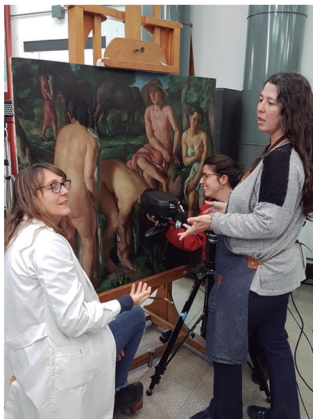
IMAGEN DERECHA Los participantes colocan el equipo de Fluorescencia de Rayos X para identificar los pigmentos.
